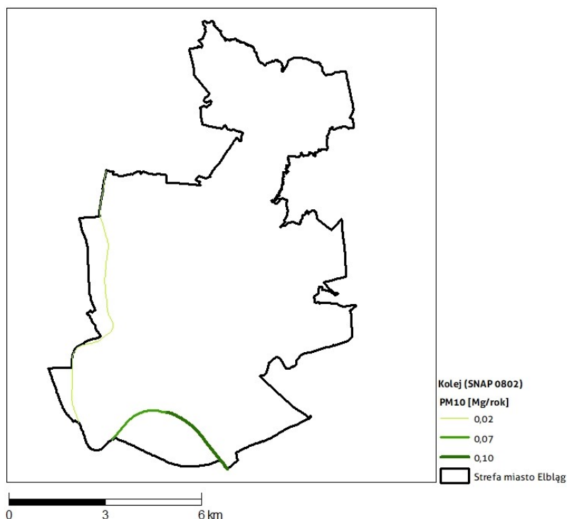
Rysunek 1-32 Rozmieszczenie oraz ładunki emisji pyłu zawieszonego PM10 w transporcie kolejowym (SNAP 0802) w strefie miasto Elbląg w 2018 r.
