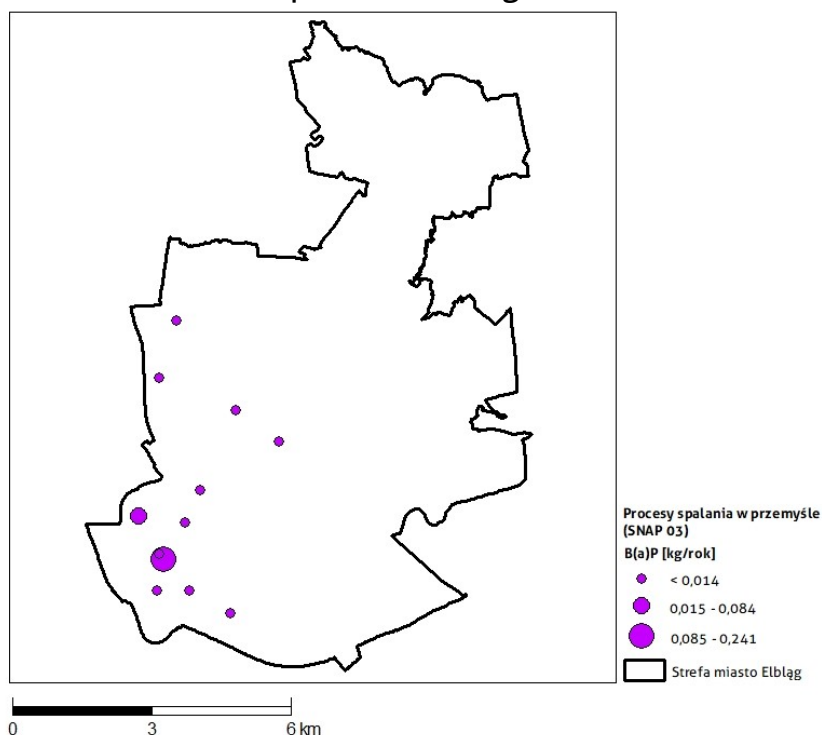
Rysunek 1-39 Rozmieszczenie oraz ładunki emisji punktowej B(a)P w procesie spalania w przemyśle (SNAP 03) w strefie miasto Elbląg w 2018 r.
